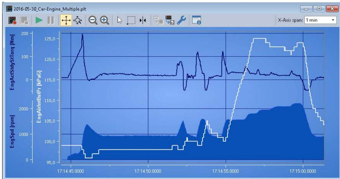
绘图仪插件允许记录和以图形表示任何数量的信号序列。信号源可以是接收和发出的CAN报文，也可以是虚拟变量和从宏计算得出的结果。
