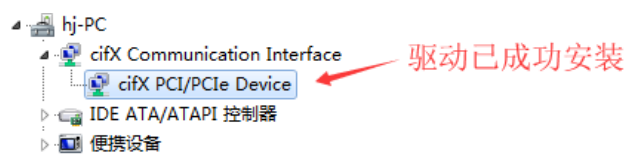
图 2.3，驱动安装完成
