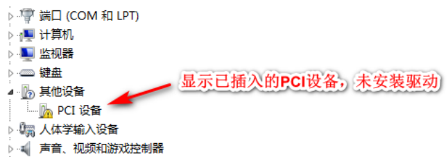
图 2.1, 已插入的 PCI 设备
