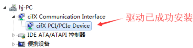
图 2.3, 驱动安装完成
