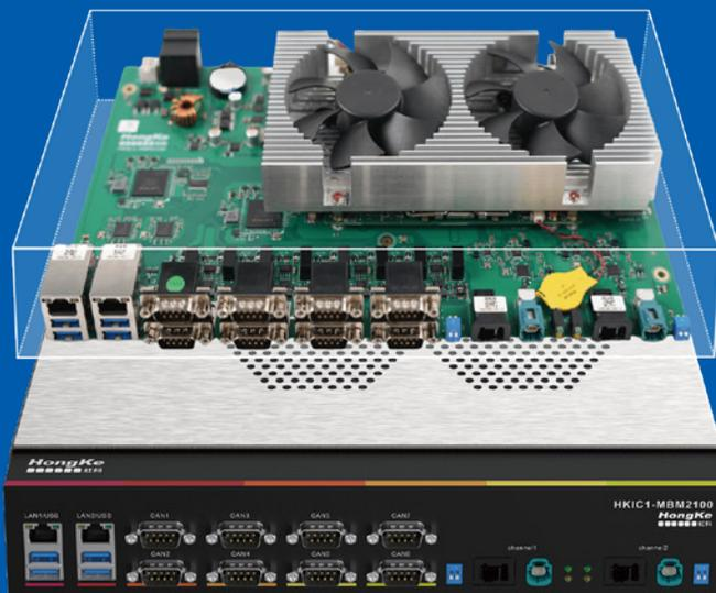
虹科车辆网络通讯测试主板是一款专为车辆网络通讯设计的高性能工控机主板，用于监控 CAN(FD)和车载以太网网络，也可以发送、保存CAN(FD)和以太网报文，具备强大的数据处理和通讯能力。它集成了 8 路 CAN/CANFD 接口以及 2 路1000BASE-T1接口，能够满足复杂车辆网络环境下的测试、监控和数据传输需求，广泛应用于汽车研发、智能交通、车辆检测等领域。
