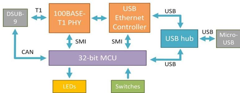
该接口卡可在非屏蔽双绞线 OABR 端口和 USB-LAN 端口之间建立点对点链接，并可作为网络接口卡使用，允许用户配置网络适配器的参数，如 IP 地址和掩码。转换器配有 DSUB9 (BroadR-Reach、CAN 总线) 和 Micro-USB 接口。OABR 通道的主/从配置可通过开关按钮或编程方式选择。
